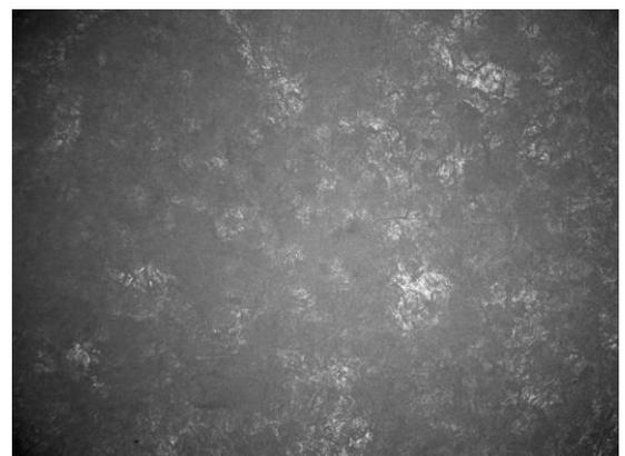
Abb. 2 Getrocknete Nanocelluloseschicht auf Papier
