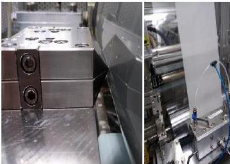
Abb. 1 Schlitzdüsenbeschichtung von Papier mit Nanocellulose
