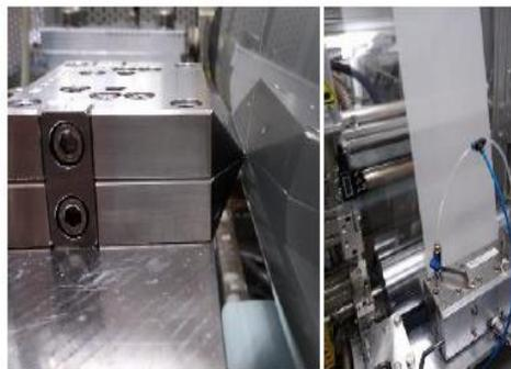
Abb. 2: Schlitzdüsenbeschichtung von Papier
