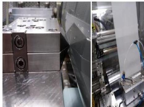
Abb. 1 Schlitzdüsenbeschichtung von Papier
