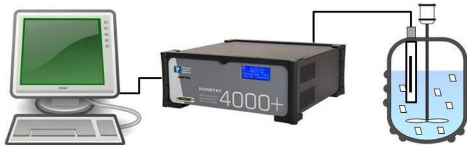
*Versuchsaufbau zur Impedanzspektroskopie/Experimental setup for impedance spectroscopy*
